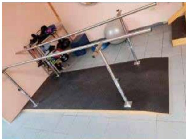
FABRICADO EN ACERO INOXIDABLE TIPO. 304 GRADO QUIRÚRGICO CON UN LARGO DE 2.13MTS, CON PLATAFORMA DE MADERA DE PINO DE PRIMERA CON TERMINADO DE BARNIZ, FORRADA CON ANTIDERRAPANTE Y PERILLAS DE PRESIÓN SUS DIMENSIONES APROXIMADAS SON 60 CM DE ANCHO Y 50 CM DE ALTO AJUSTABLE A ALTURA
