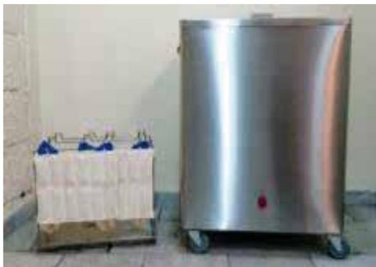
FABRICADOS EN SU TOTALIDAD DE ACERO INOXIDABLE TIPO.304 GRADO QUIRÚRGICO CAL.18 CON ACABADO SANITARIO PARA EVITAR LA INFORMACIÓN DE BACTERIAS, CON FALSO FONDO CAL.20 Y VARILLA CAL. 3/16, AGARRADERAS Y BISAGRAS DE 1", CUENTA CON RESISTENCIA DE 1100 WATTS Y UN TERMOSTATO DE 30°C A 110°C.
